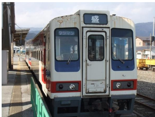
車両は津波による塩害で走行は不能になった。
